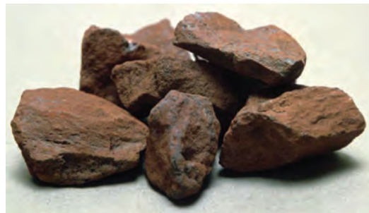
شکل ۸- سنگ معدن حاوی FeO و Fe_2O_3
