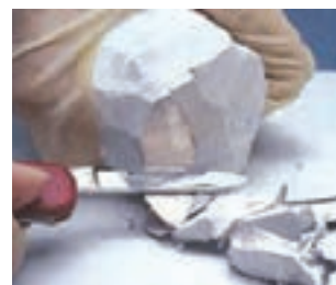
شکل ۵- الف) جلای نقره ای فلز سدیم در مجاورت هوا به سرعت از بین می رود و سطح آن کدر می شود.
