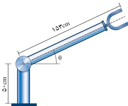
❁ **مثال:** روبات‌ها در زمینه‌های مختلف کاربرد دارند. در طراحی انواع روبات‌ها از توابع مثلثاتی استفاده می‌شود. در شکل روبه‌رو یک روبات صنعتی را که در صنایع خودروسازی کاربرد دارد مشاهده می‌کنید. با توجه به مقادیر داده شده، ارتفاع نوک گیره روبات را از به سطح زمین به کمک یک تابع مثلثاتی مدل‌سازی کنید.  $(0 \leq \theta \leq \frac{\pi}{4})$ .
