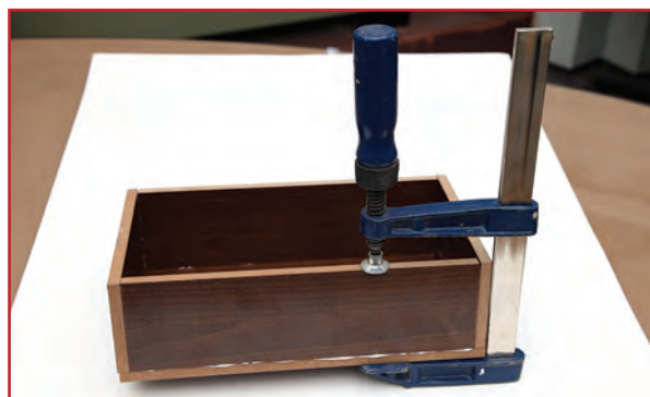
شکل ۷-۱۶- بستن جعبه به وسیله پیچ دستی
