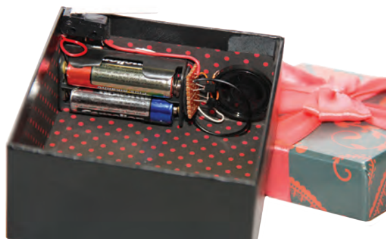
شکل ۲۸-۲- جانمایی مدار پروژه و کلید
