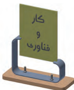
شکل ۳۹-۱- متصل کردن قطعات با پیچ و مهره شکل ۴۰-۱- قرار گرفتن گل پیچ با قطر ۸ میلی‌متر شکل ۴۱-۱- قرار گرفتن شیشه‌ها در شیارهای قاب عکس
