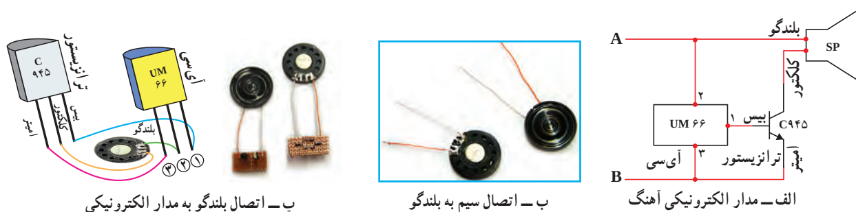
شکل ۲-۲۶- مدار الکترونیکی جعبه آهنگ
